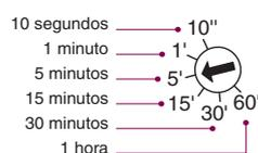
La temporización deseada se puede ajustar de 10 s, 1 min, 5 min, 15 min, 30 min a 1 hora por pasos.
